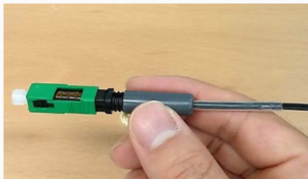
11. Apriete la capa junto al hilo sobrante fuera del conector. Y corte el resto del hilo.
